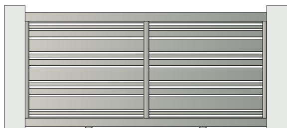
Nordet C Remplissage horizontal Lames de 40, 80 et 160 mm
